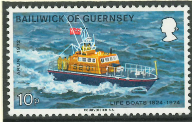
„ARUN” lifeboat na każdą pogodę, w służbie od 1971 do 2008 wyp. 33, 16x5,2m, zan.1,5m v 18, 5w, zasięg 250mil załoga 6. Zbudowano 46 jednostek, pływają po całym świecie.
