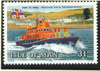
Lifeboat klasy Arun „GOUGH RITCHIE” 54-06 baza Port St. Mary Wyp. 33, 18x5,3, zan. 1,5m v 19w, załoga 6 osób.
