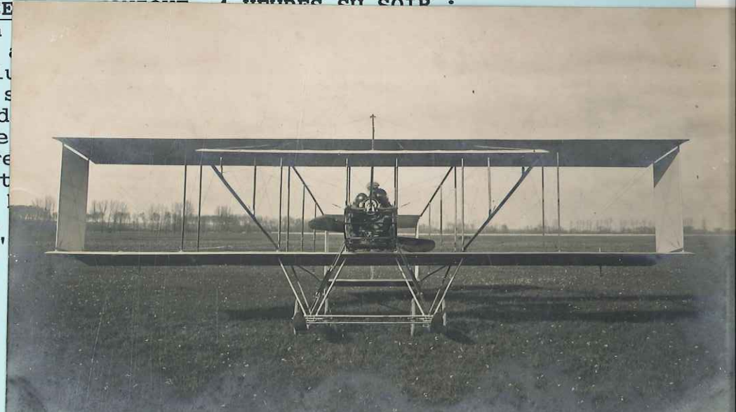
SEMAINE D'AVIATION DE TOURAINE (30 avril - 5 mai 1910). — Édition officielle. (ND Phot.) 17 — CHATEAU, sur biplan Zodiac, inédit; moteur rotatif Gnome de 50 HP.; hélice en bois Sizius.
